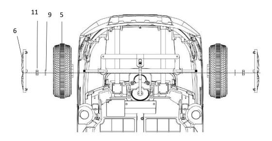
Puis clipser les enjoliveurs (6) sur les roues avant (5), grâce aux 3 encoches de clipsage.
