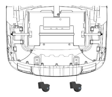
Sur la partie avant du véhicule, à l'aide des 2 clefs à molette (18), dévissez et retirez les 2 écrous M8 (11) des extrémités de la barre de direction avant et sortez 2 rondelles M10 (9) sur les 4 préinstallées. Veillez à laisser 2 rondelles M10 (9) sur la barre de direction.
