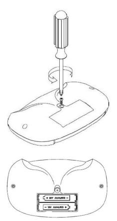
Soulevez le couvercle du compartiment à piles à l'arrière de la télécommande et insérez deux piles AAA (1.5V) (non incluses), faites attention à la polarité, fermez le couvercle du boîtier de la télécommande, serrez la vis pour fixer le couvercle (pour changer la pile, veuillez-vous reporter à la section correspondante). Les bornes d'une pile ou d'un accumulateur ne doivent pas être mises en court-circuit.
