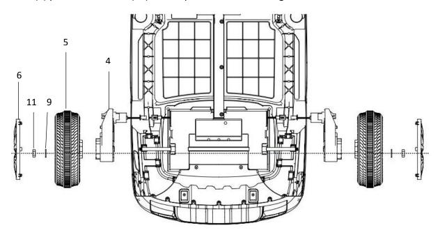
Puis clipser les enjoliveurs (6) sur les roues avant (5), grâce aux 3 encoches de clipsage.
